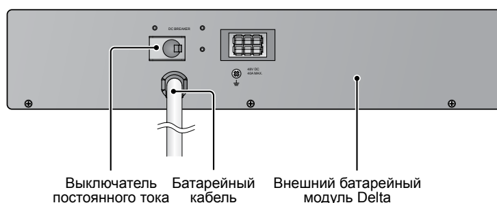
Рис. 4-1. Внешний батарейный модуль Delta, вид сзади
